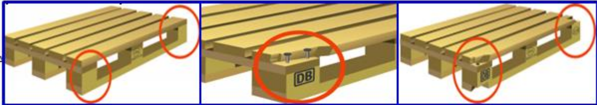
Fehlende EUR Markierung
